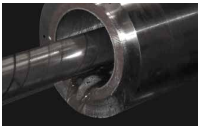
Augmentation du diamètre interne par rodage.
