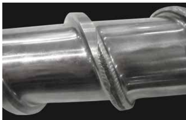
Régénération des filets des vis par dépôt de plasma.
