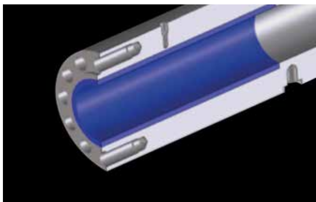
Réparation par l'insertion d'une chemise à l'avant du fourreau (injection).
