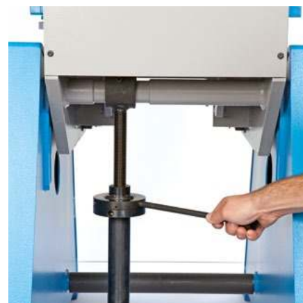
Réglage de l'inclinaison (hydraulique sur 45 et 80T)
