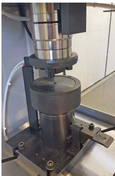
► 13T HYDRO avec outillage de déformation
