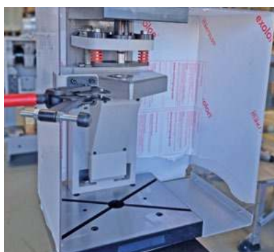
► 7T HYDRO avec outillage de découpe de Ø dans des bacs plastiques
