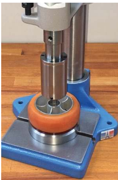
► 4HR avec outillage de montage de roulement
