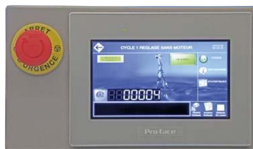
Pupitre standard de commande des presses mécaniques
